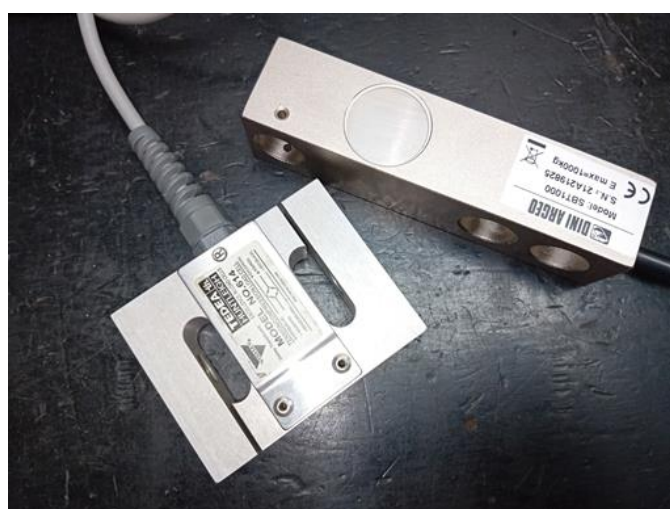
Obrázek 9 – Detail použitých tenzometrických snímačů síly
