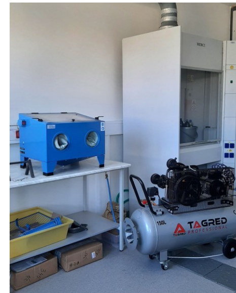
Tryskací box a digestoř
