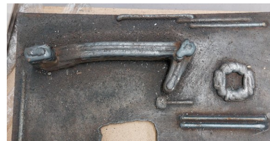
Navařování páky metodou WAAM
