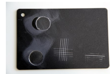
Mřížková a odtrhová zkouška
